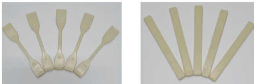
Figura 3: Corpos de prova de tração e flexão obtido após o processo de reciclagem das embalagens
