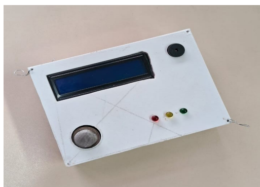
Figura 5 – Sistema físico do sensor de gás móvel.
