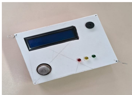
Figura 5 – Sistema físico do sensor de gás móvel.
