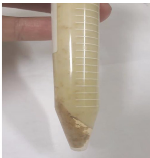
Figura 2: Teste de centrifugação creme após teste de congelamento/descongelamento.
